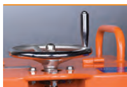
Koło ręczne z bezkońcową śrubą systemu kontroli głębokości.
