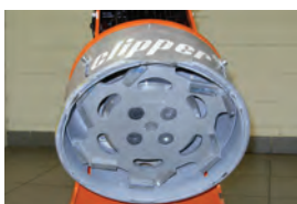
Szerokość szlifowania do 250 mm
