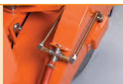
System kontroli przepływu wody po obu stronach maszyny.
